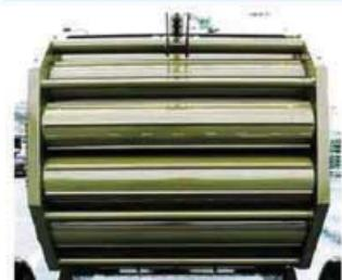
Trục cuộn bằng thép đặc biệt hoạt động ổn định và êm ái tạo lực cuộn ép rất chặt cho cuộn rơm. Trọng lượng và độ lỏng – chặt của sản phẩm điều chỉnh được bằng 3 mức của chốt định vị.
