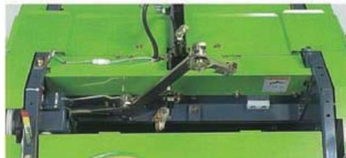
Khi cuộn rơm đã đủ tiêu chuẩn, máy sẽ báo hiệu bằng tiếng kèn để người sử dụng dừng máy cày. Thao tác quấn dây và thắt nút được tự động thực hiện. Số dây quấn có thể điều chỉnh từ 8 → 10 vòng.
