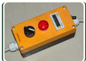
Hộp điều khiển có nút nhả rơm, còi báo và đồng hồ đếm cuộn rơm
