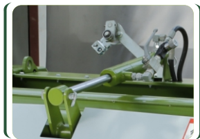
Điều khiển tay ben nhả rơm bằng điện
